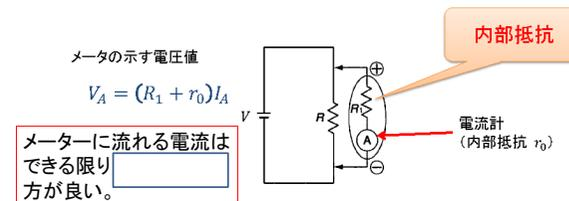
電圧を正しく測るためには、 $R_1 \gg r_0$  であることが必要。
