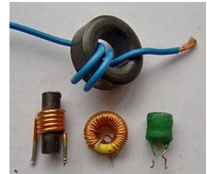
コイルの作る磁界を打ち消す向きに誘導起電力が発生する。
